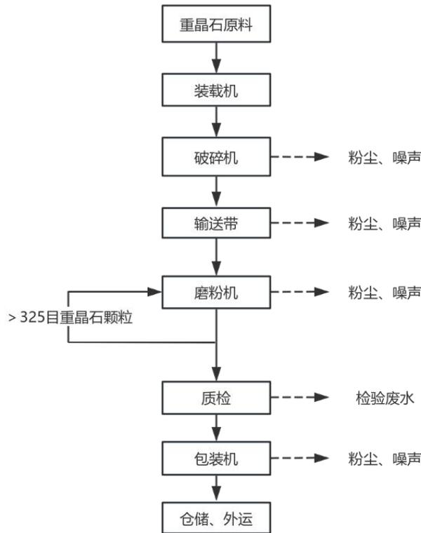
图 2-3 生产工艺流程及产污环节图
