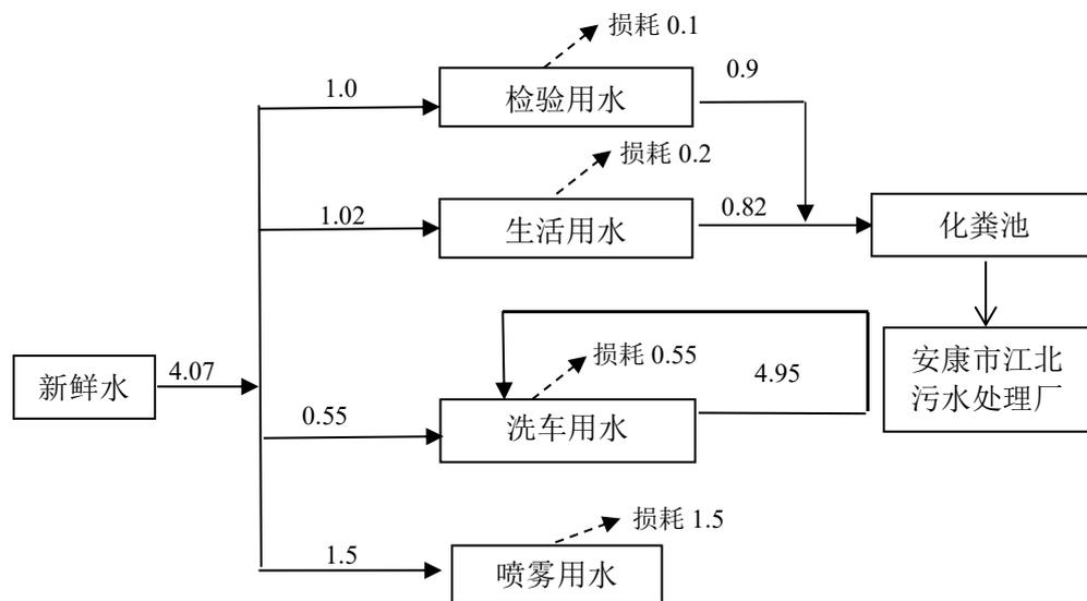
图 2-1 项目水平衡图（单位：m<sup>3</sup>/d）
