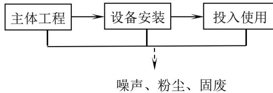
图 2-2 项目施工流程及产污环节分析图
